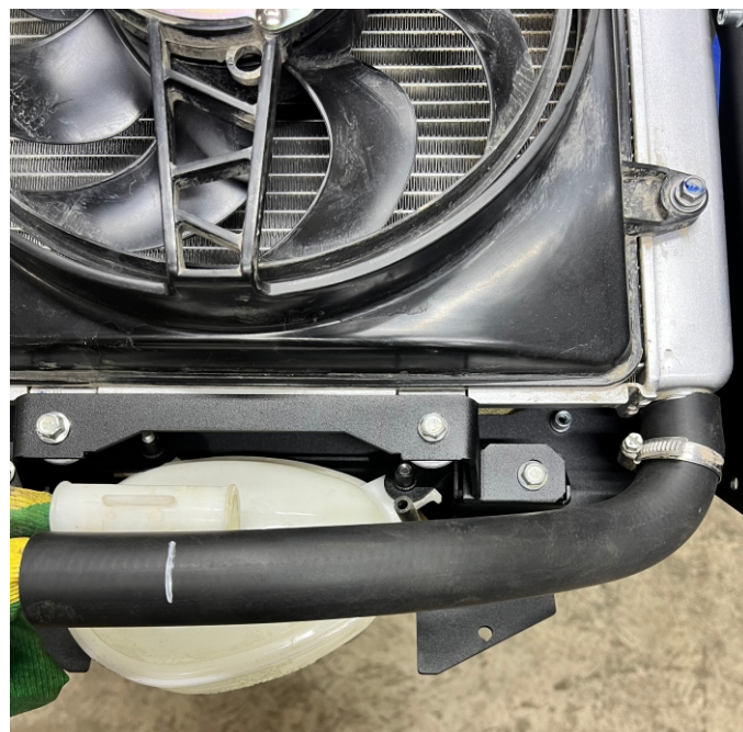
11. Устанавливаем патрубок из комплекта для соединения бачка с верхним штуцером радиатора, при необходимости отрезаем часть патрубка. Монтируем вынос радиатора с площадками на транспортную площадку квадроцикла.
