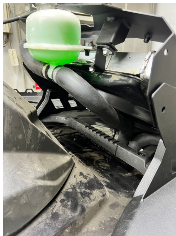
13. Подключение патрубка из комплекта к бачку. После протяжки всех соединений заливаем антифриз в систему, подключаем фишки вентилятора.
