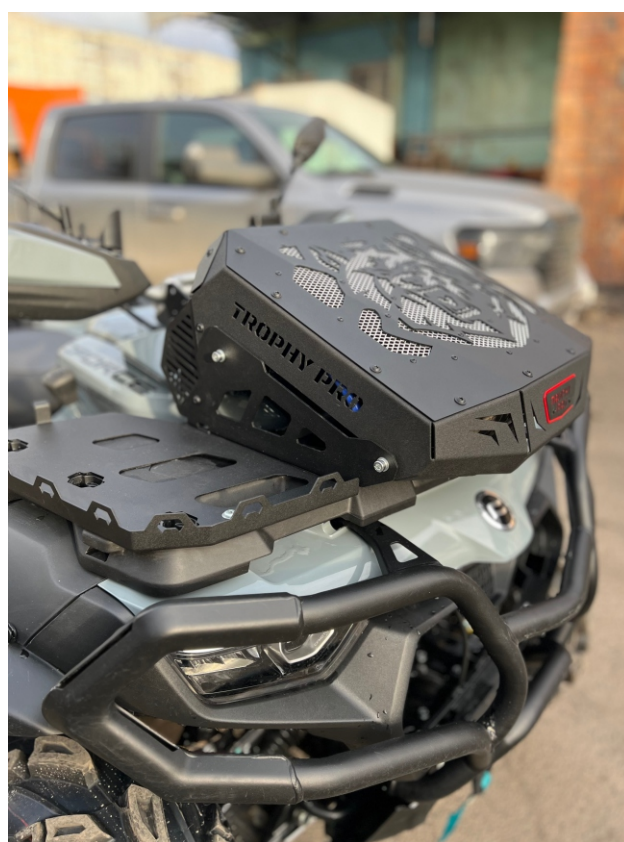
25. Общий вид выноса радиатора со шноркелями и транспортными площадками в собранном виде.
