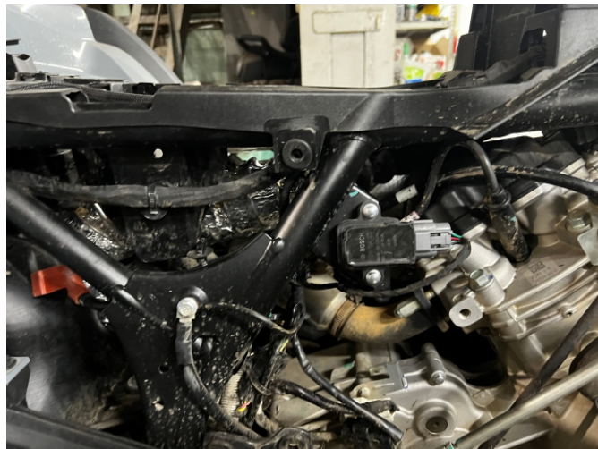
8. Прокладка воздуховода выдоха вариатора, вид справа.
