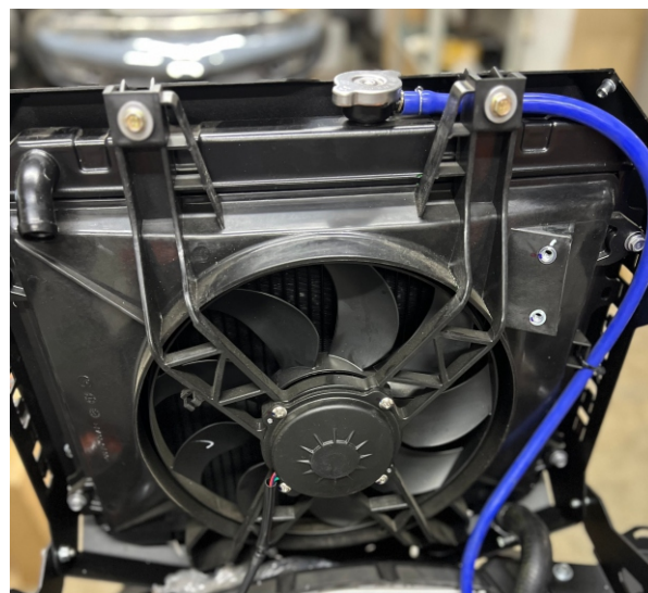
20. Устанавливаем вынос радиатора на кронштейны, установленные в штатные отверстия площадки, не затягивая до упора. Подключаем шланги системы охлаждения, также переливную трубку к расширительному бачку, фиксируем их стяжками к трубе площадки. Заливаем антифриз обратно в систему, выравниваем уровень в расширительном бачке до MAX. Даем поработать двигателю до срабатки вентилятора и его отключения, при необходимости подливаем антифриз.
