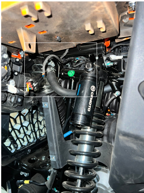
17. Схема подключения левого патрубка через прямой соединитель.
