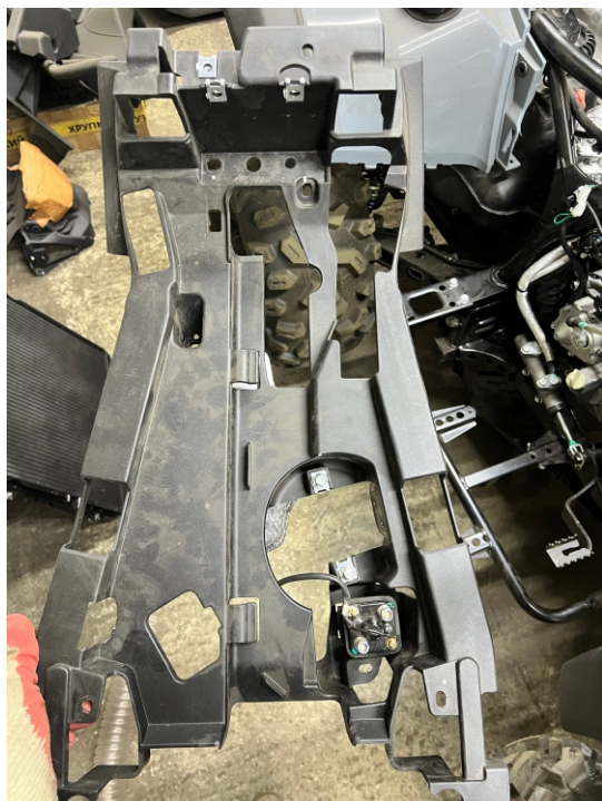
4. Производим демонтаж защитного пластика из-под сиденья для последующей прокладки воздуховода вариатора.
