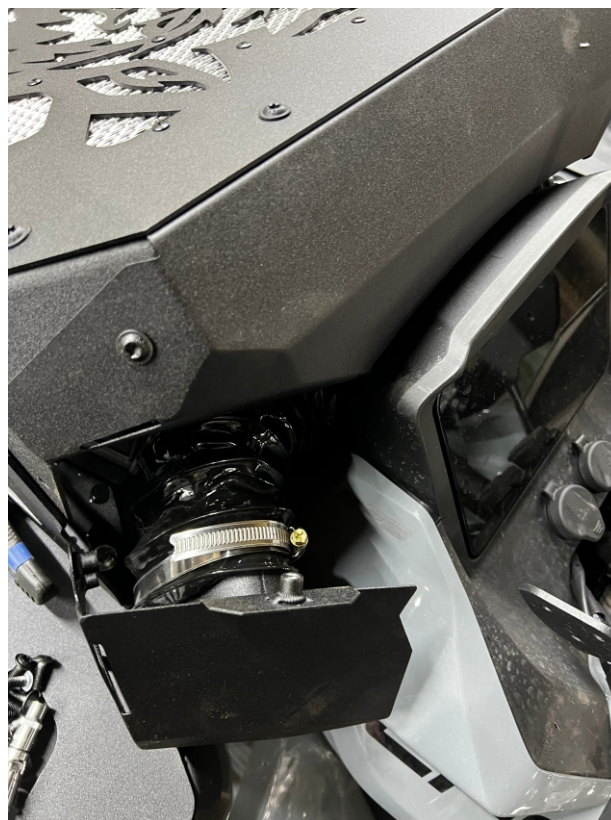
22. Подключаем левый воздухозаборник на штуцер шноркеля
