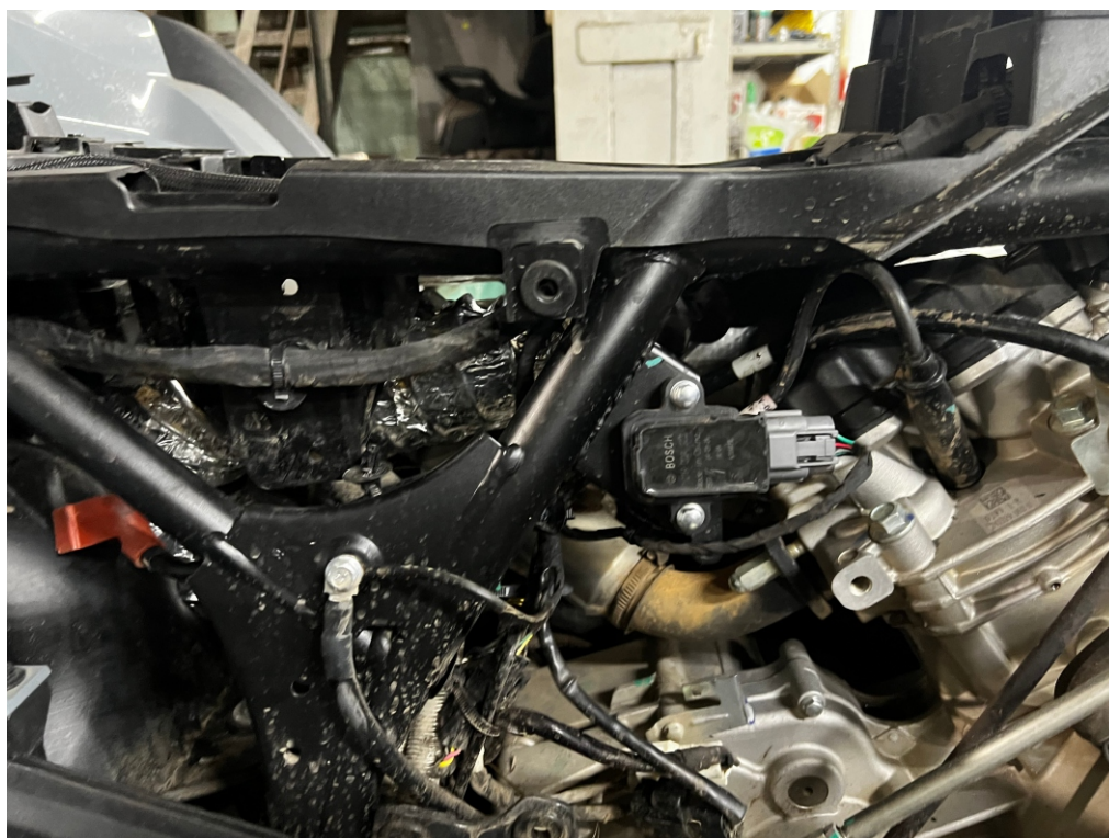
6. Извлекаем штатный пластиковый шноркель от вариатора, в резиновую муфту устанавливаем переходную втулку из комплекта, фиксируем воздуховод на муфте хомутом. Рекомендуется монтировать соединения при помощи автомобильного герметика. Воздуховод в непосредственной близости к выхлопной системе дополнительно проклеить фольгированным скотчем.
