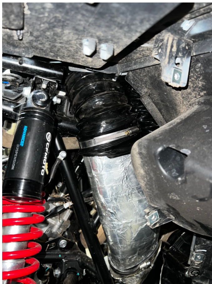
10. На штатном шноркеле входа вариатора отпиливаем верхнюю часть, для удобной посадки воздуховода.
