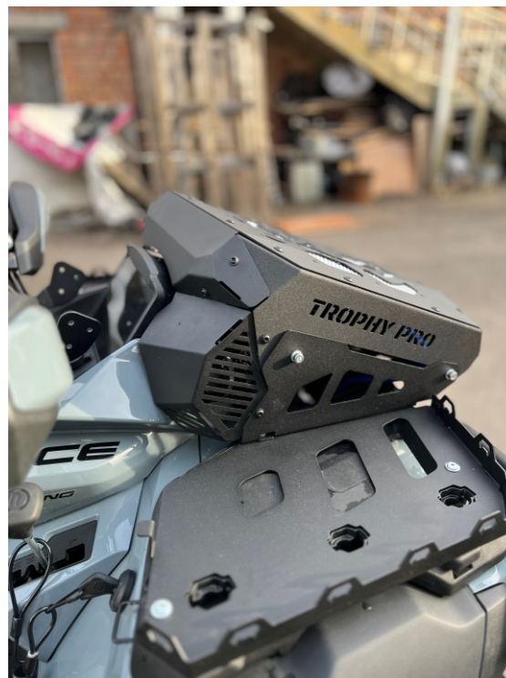
24. Устанавливаем в корпус выноса шноркеля.
