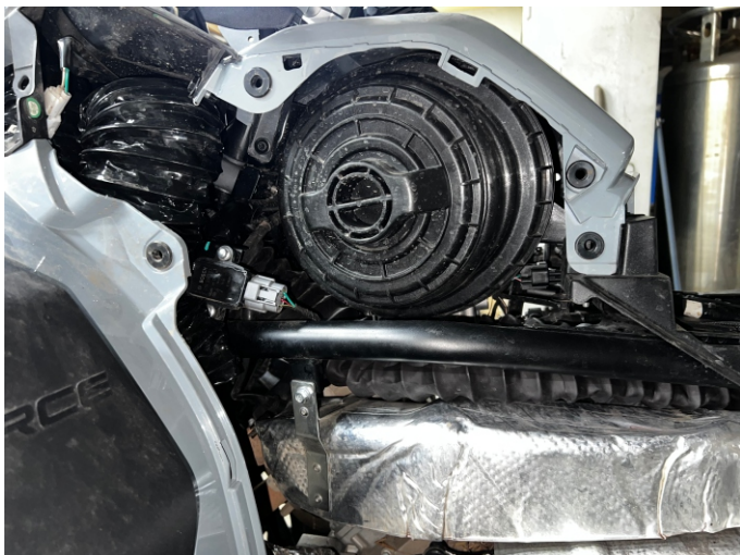
7. Прокладка воздуховода выдоха вариатора, конец воздуховода выводится в передней части к щитку приборов делая петлю, конец воздуховода направляется в область двигателя.
