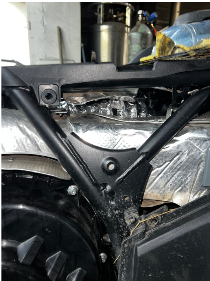
9. Прокладка воздуховода выдоха вариатора, вид справа.
