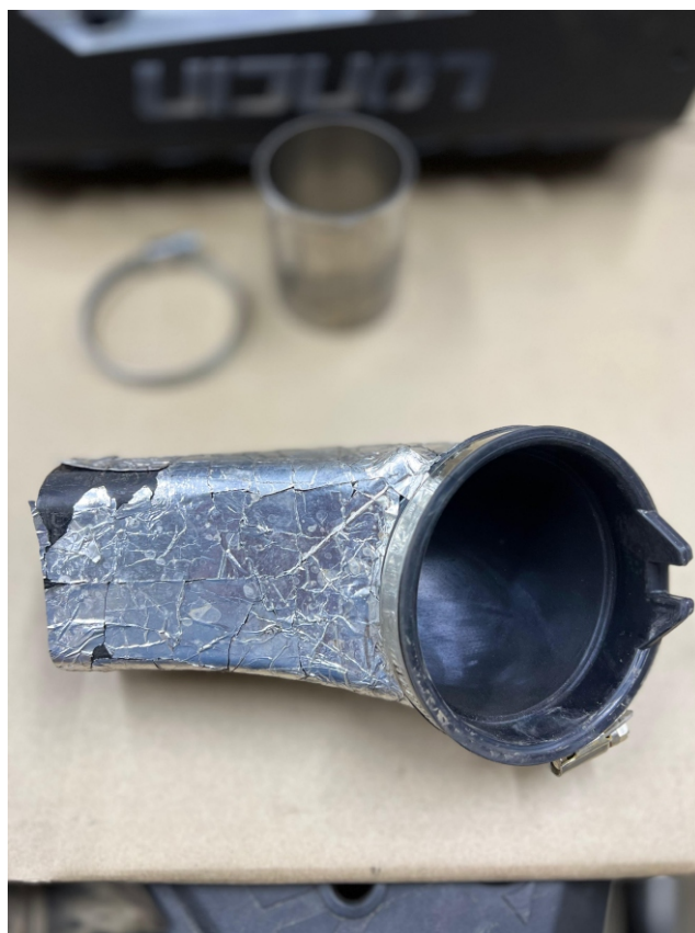
13. Обрезаем патрубок и стыкуем с соединителем 63 мм для дальнейшего подключения воздуховода.
