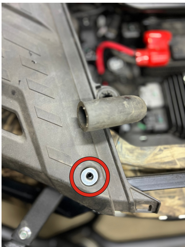
24. Между пластиком и кронштейнами выноса прокладываем упоры из набора шайб M10 до уровня верхней поверхности пластика, чтобы вынос прочно фиксировался на площадке и давил на металлический корпус площадки, а не на пластик.
