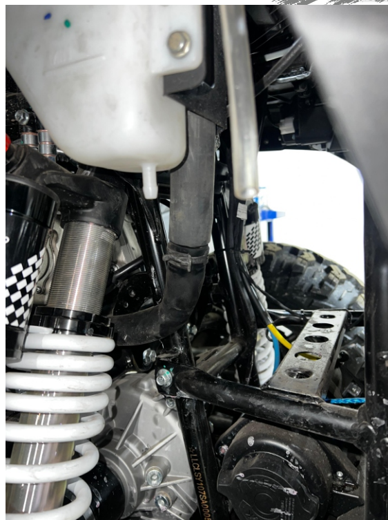
8. Подключение правого (нижнего) патрубка, на прямой соединитель.
