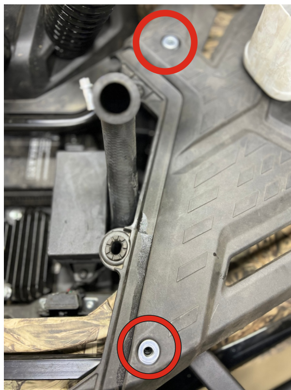
24. Между пластиком и кронштейнами выноса прокладываем упоры из набора шайб M10 до уровня верхней поверхности пластика, чтобы вынос прочно фиксировался на площадке и давил на металлический корпус площадки, а не на пластик.
