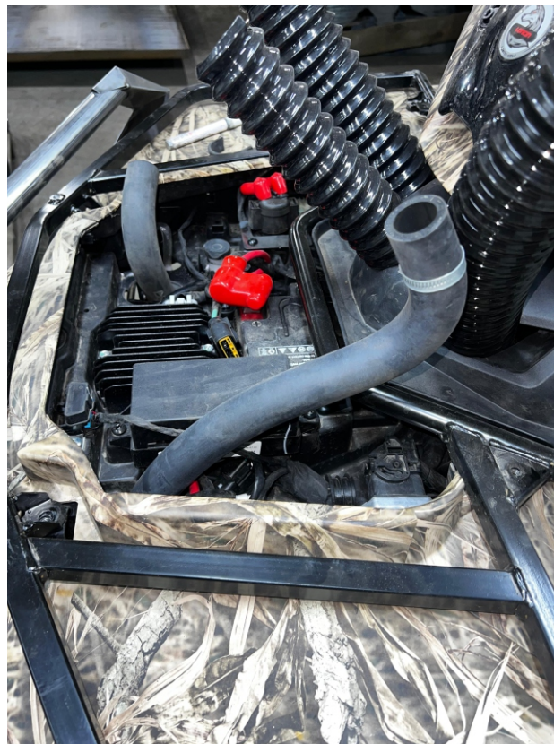
10. Схема вывода патрубков из-под капота
