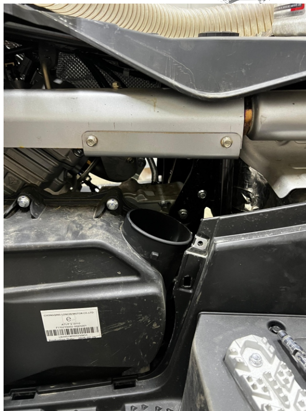
12. Демонтируем задний резиновый патрубок с вариатора.
