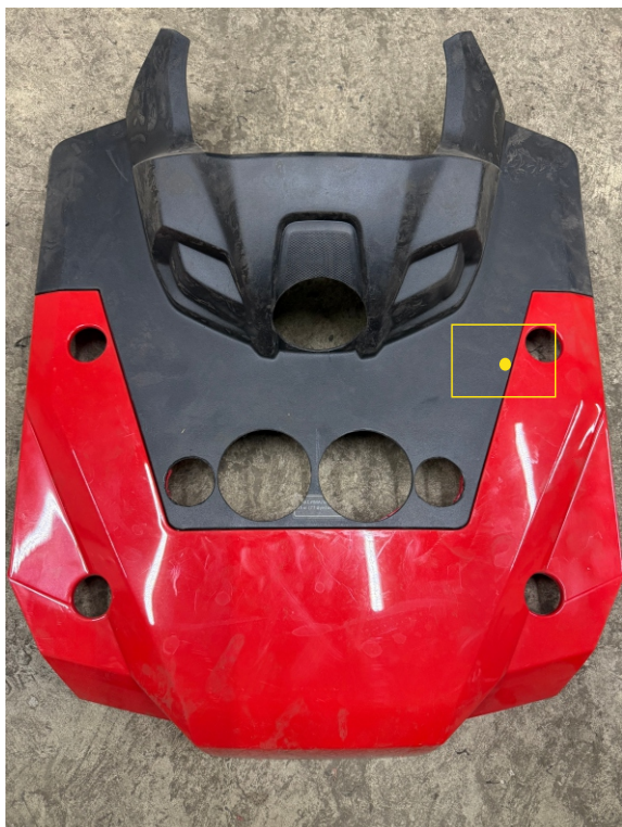
16. Сверлим отверстия под воздуховоды коронкой 68-73 мм, отверстия для патрубков 32-40мм диаметром. На подкапотном пластике сверлим аналогичные отверстия в проекции. в выделенном месте делаем выпил под провод вентилятора.
