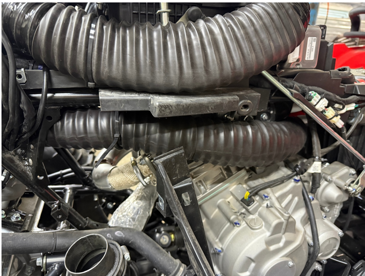
12. Схема прокладки воздуховода с выхода вариатора, воздухопровод фиксируем стяжками к раме. Длина воздуховода в растянутом виде 1,5 м.
