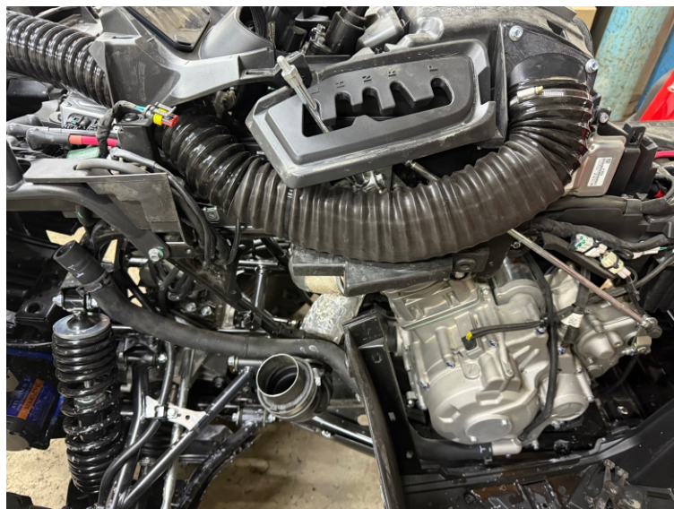
11. Схема прокладки воздуховода с воздушного фильтра, фиксируем стяжками к раме. Длина воздуховода в растянутом виде 1,2 м.
