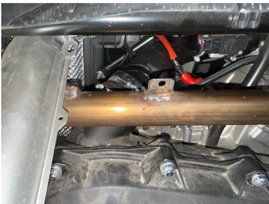
8. Демонтируем с корпуса фильтра резиновый шланг, зачищаем поверхность от герметика на его место устанавливаем пластиковый шланг из комплекта, герметизируя соединение.
