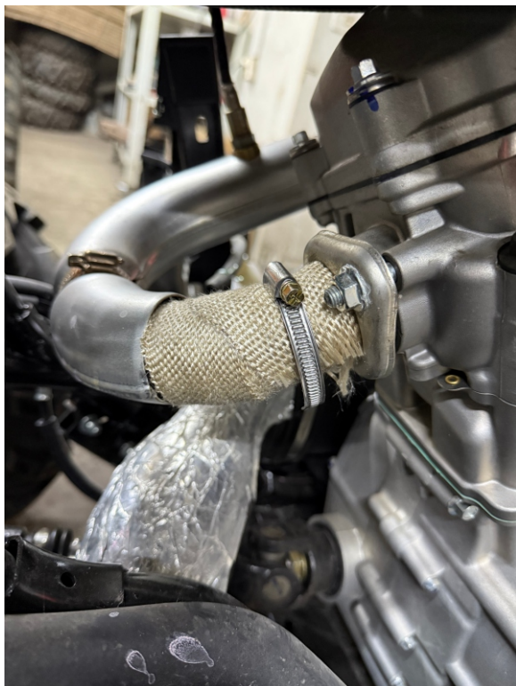
10. В передней части также обматываем открытый участок трубы термолетной.
