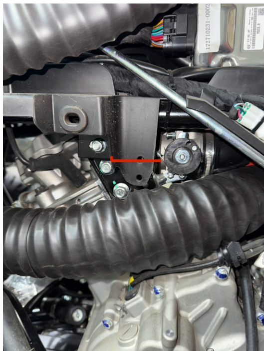
9. Устанавливаем воздуховод на выход радиатора, для лучшей прокладки отрезаем указанную часть пластика. Рекомендуется снять отражатель выхлопной трубы и трубу обмотать термолентой для глушителей (в комплект поставки не входит), закрепив хомутами, после чего экран установить на место.
