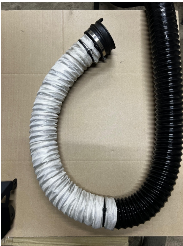
6. Монтируем металлический штуцер на резиновый патрубок, затем крепим на него воздуховод и обматываем стеклолентой из комплекта, примерно 50-60 см, фиксируем стяжками по краям.
