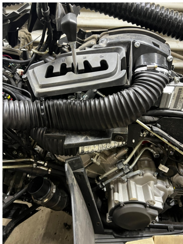
8. Монтируем воздуховод на воздушный фильтр, с термоусадкой, прокладываем его в переднюю часть квадроцикла.
