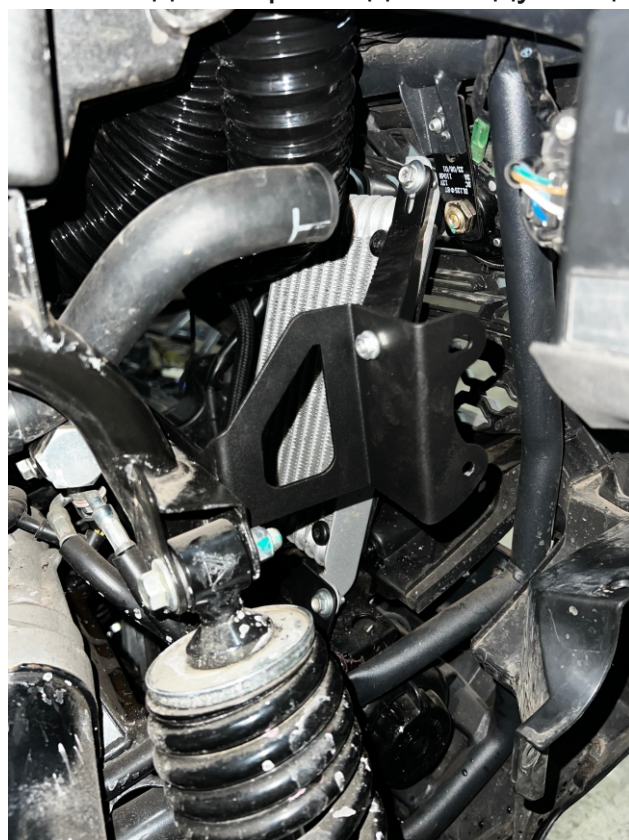
10. Устанавливаем расширительный бачок, используя кронштейн из комплекта. Крепим его в штатные места, на него монтируем верхний кронштейн масляного радиатора.
