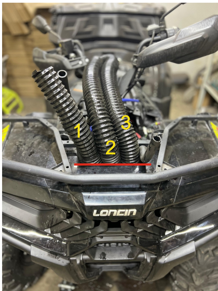
9. Выводим воздухопроводы из капота наружу. В передней части на пластике внутри капота делаем выпил для свободного пролегания воздухопроводов. 1 - выпуск вариатора, 2 - впуск вариатора, 3 - впуск двигателя. Выводим патрубки системы охлаждения.
