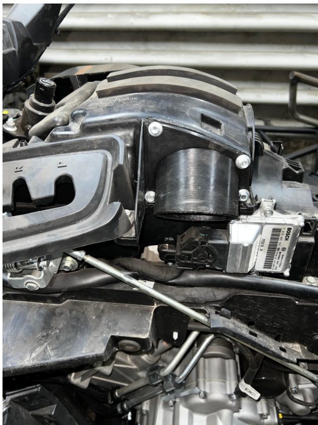
7. Демонтируем резиновый воздуховод с корпуса воздушного фильтра, зачищаем поверхность от герметика. На его место устанавливаем штуцер из комплекта, предварительно прогерметив соединение.
