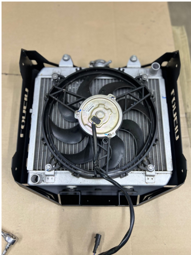
4. Монтируем радиатор в корпус выноса, вентилятор разворачиваем на 180 градусов.
