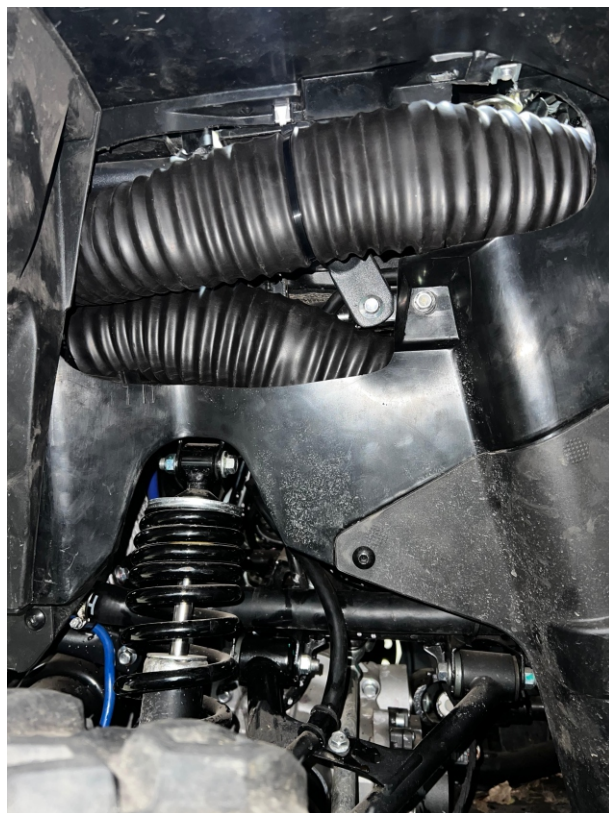
8. При установке пластика делаем выпил для свободной прокладки воздухопроводов
