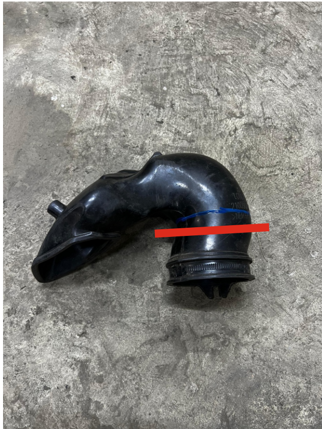
5. Демонтируем резиновый патрубок с выхода вариатора, отрезаем нижнюю часть.
