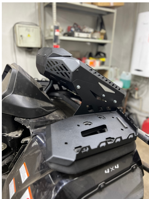
14. После выравнивания уровня антифриза устанавливаем крышки на корпус выноса радиатора, делаем протяжку всех соединений.
