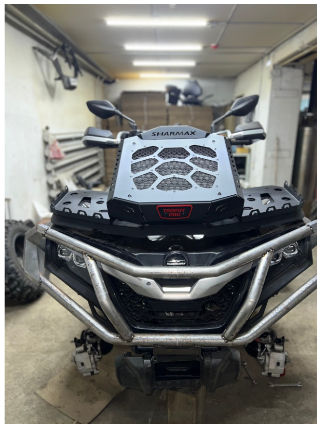
13. Устанавливаем панель на вынос радиатора.
