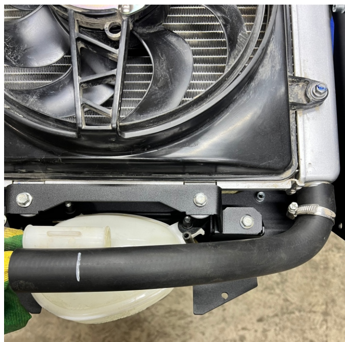
6. Устанавливаем патрубок из комплекта для соединения бачка с верхним штуцером радиатора, при необходимости отрезаем часть патрубка. Монтируем вынос радиатора с площадками на транспортную площадку квадроцикла.
