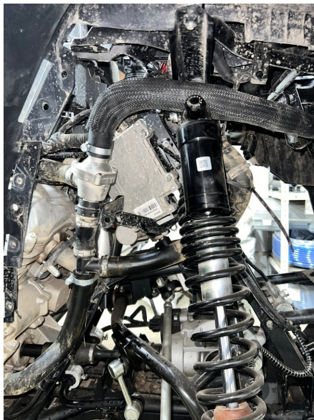
9. На верхний патрубок надеваем оплетку от штатного патрубка на верхний патрубок. Монтируем патрубок из комплекта на термостат, соединяем нижний патрубок с тройником после обрезки. Прокладываем патрубок через отверстие в пластике капота.
