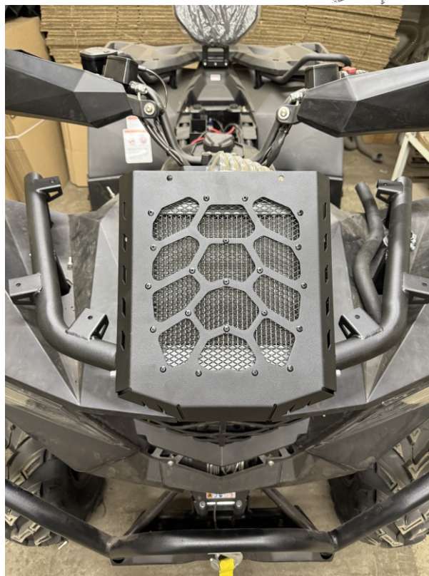
12. Монтируем трубчатые конструкции в штатные места крепления площадки, устанавливаем на них вынос радиатора. Отмечаем в проекции на пластике отверстия для прохождения патрубков подключения системы охлаждения.
