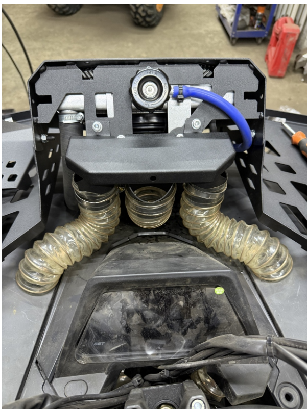
17. Устанавливаем систему шноркелей и подключаем воздухопроводы.
