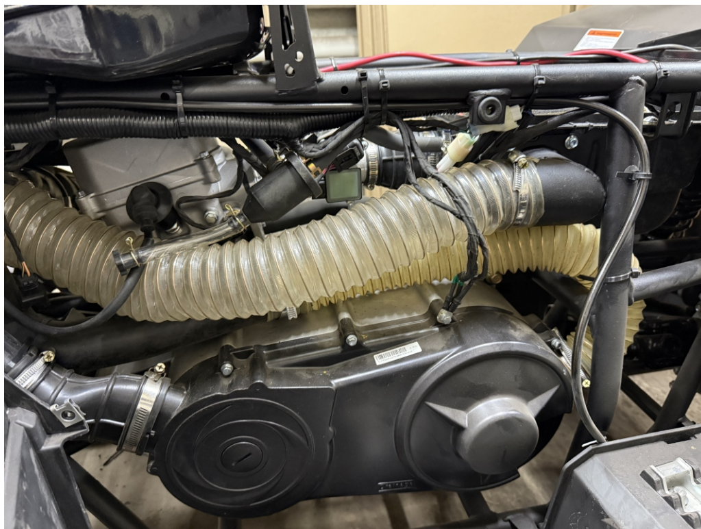
8. Монтируем воздуховод 63 мм на штуцер воздушного фильтра. Выводим в переднюю часть.
