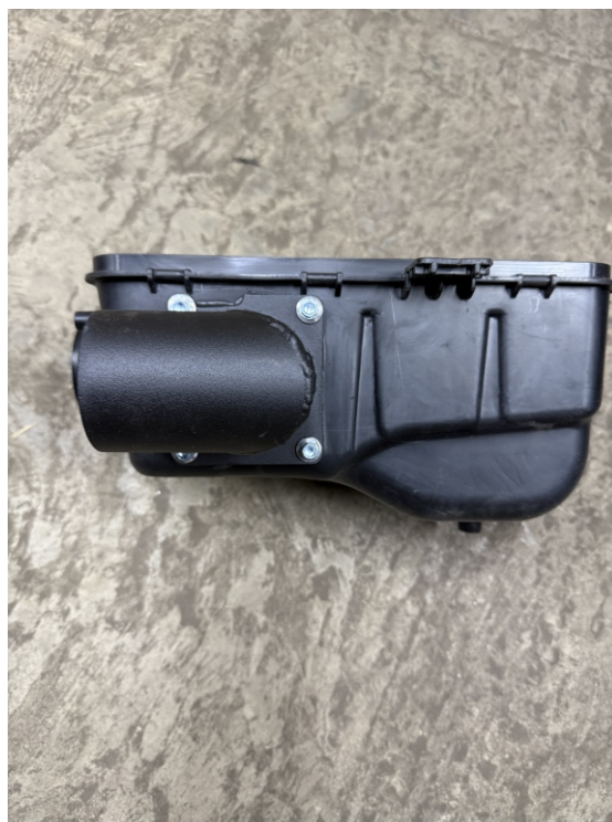
7. Монтируем штуцер на корпус воздуховода с применением герметика.
