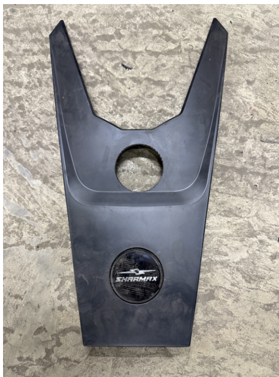
14. Сверлим отверстие под воздуховод двигателя в капоте д. 68 мм
