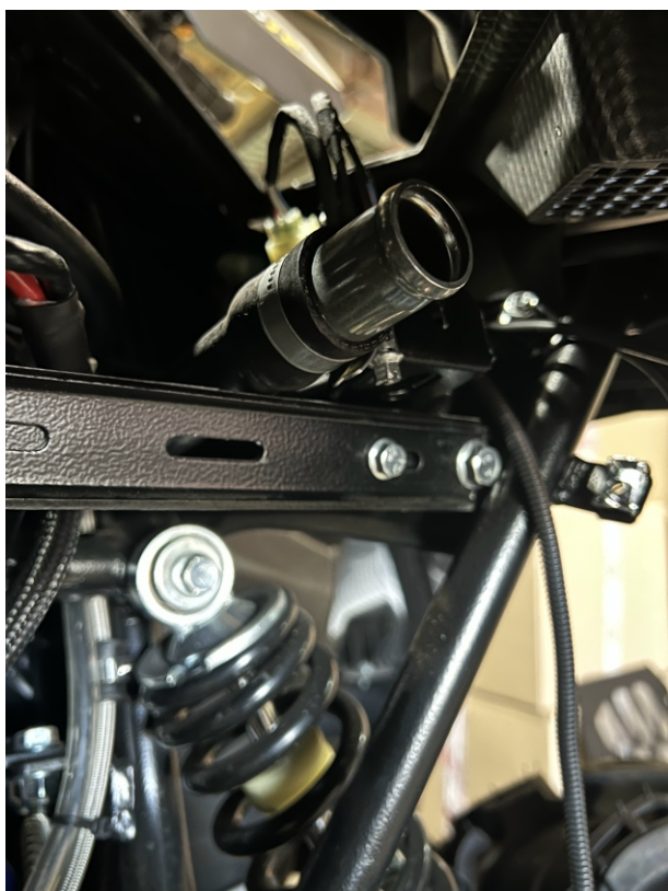
10. Монтируем прямой соединитель на верхний подводящий патрубок .
