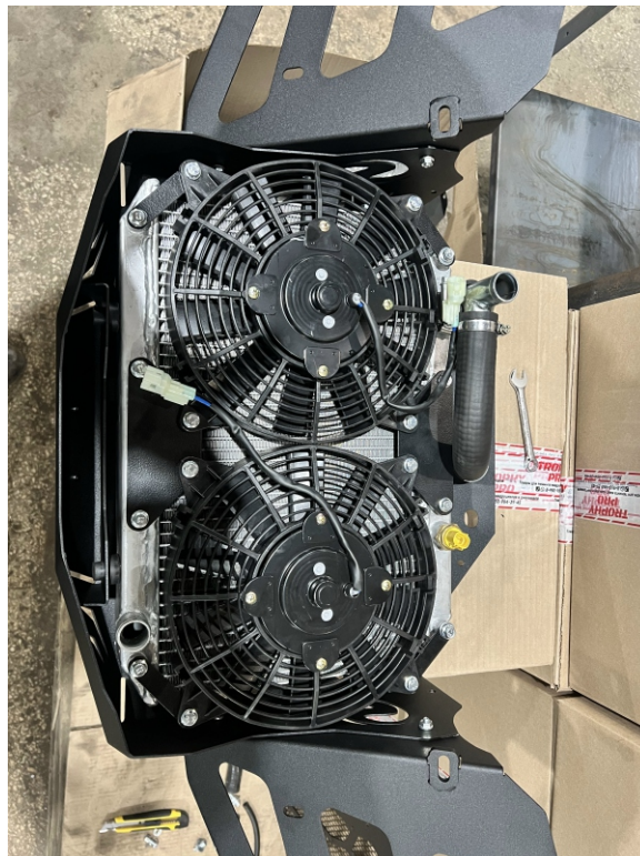
6. Устанавливаем радиатор в корпус выноса, вентиляторы переустанавливаем, развернув на 180 градусов, монтируем горловину из комплекта к корпусу радиатора, устанавливаем на неё патрубок из комплекта, на который монтируем соединитель-тройник .
