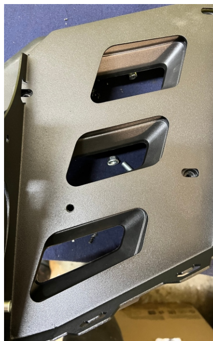
8. В собранном виде совмещаем вынос радиатора с площадками по отверстиям площадки, отмечаем расположение отверстия.
