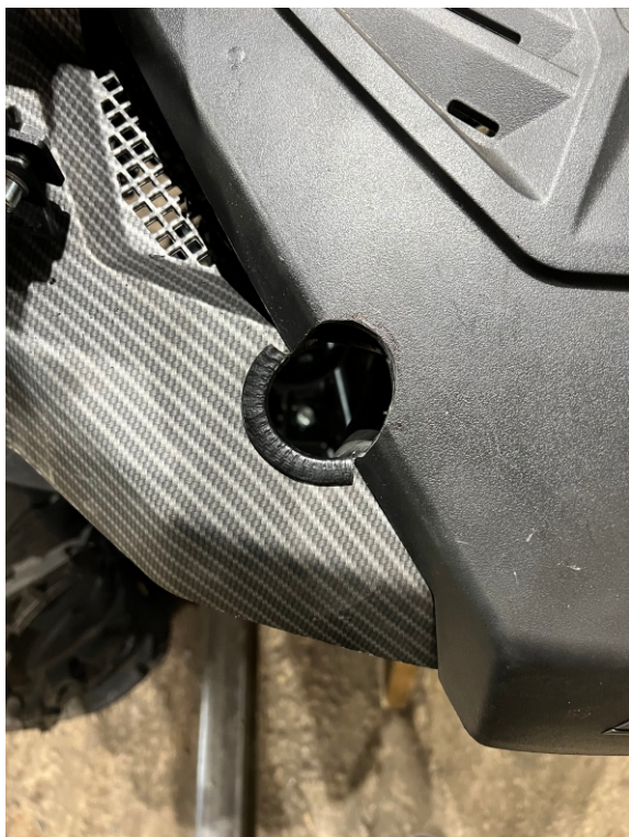
5. Сверлим отверстие на переднем пластике и капоте.
