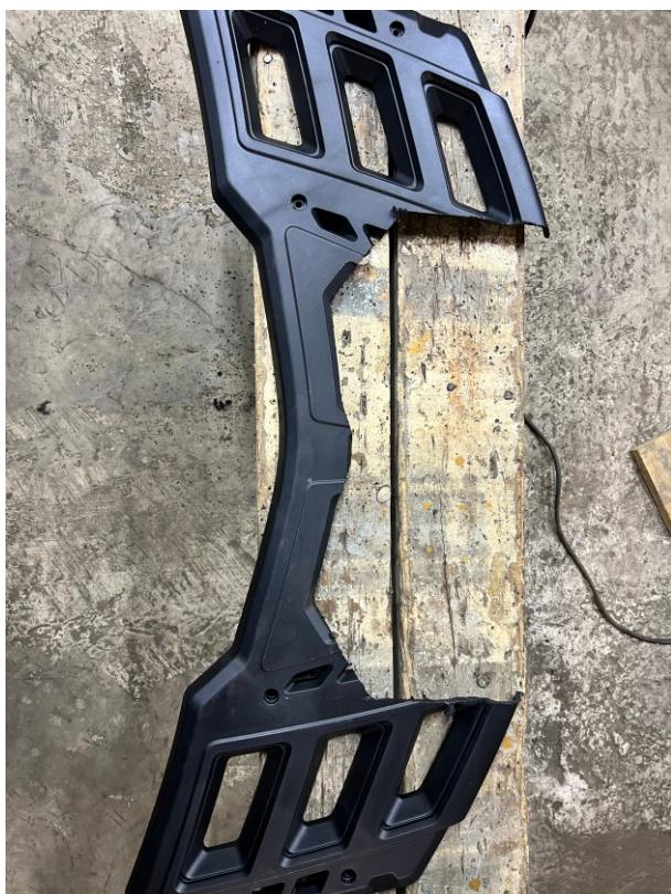
7. Выпиливаем пластик по габаритам корпуса выноса, отпиливаем трубу конструкции площадки по этим же габаритам.
