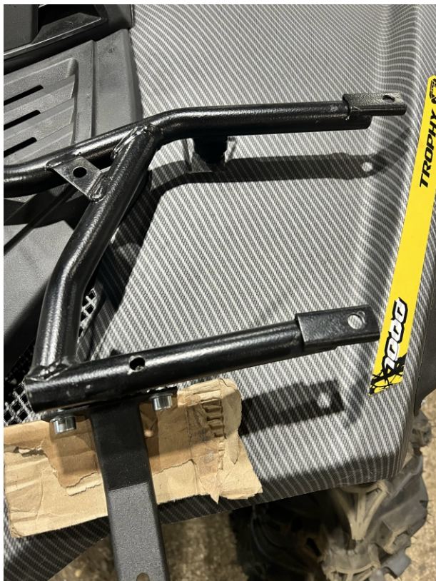
8. Сверлим отверстия диаметром 7мм в трубе с обеих сторон конструкции площадки для крепления площадок.
