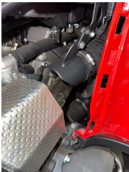
21. При монтаже воздуховода соблюдаем направление потока воздуха.
