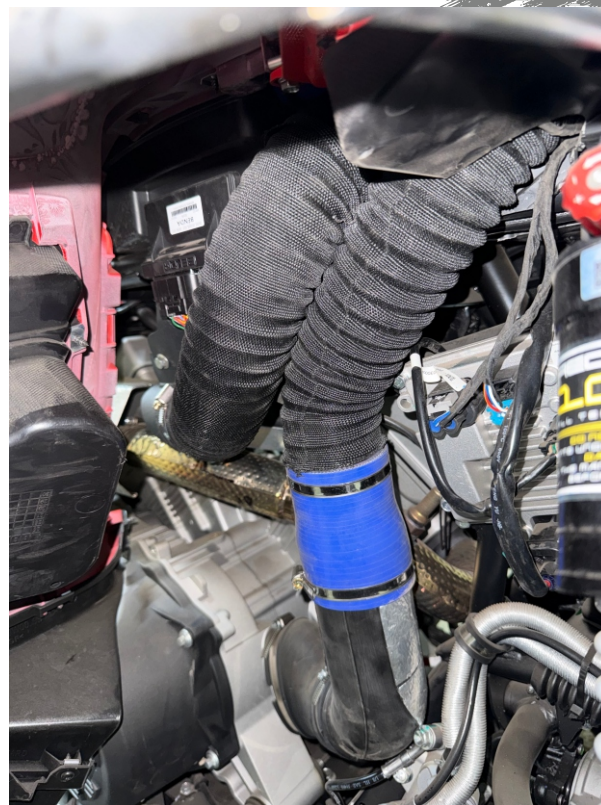
20. Прикручиваем штуцер к заранее закрепленному кронштейну под блок управления, направляем штуцер на трубу.
