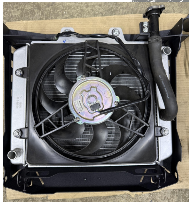
28. Монтируем радиатор в корпус выноса, крепим заливную горловину, отрезаем выступающий конец заливного патрубка до нужной длины.
