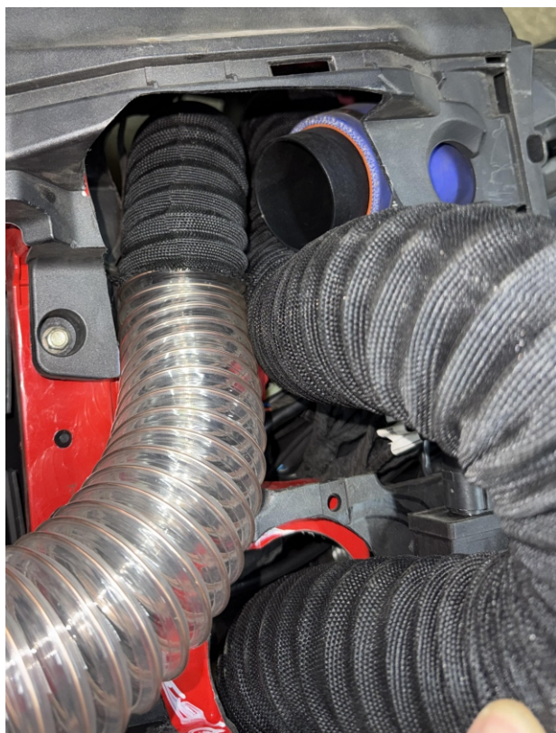
19. Прокладываем выход вариатора со штуцером к выхлопному колену двигателя. Под приборной панелью оставляем петлю высотой 20 см.
