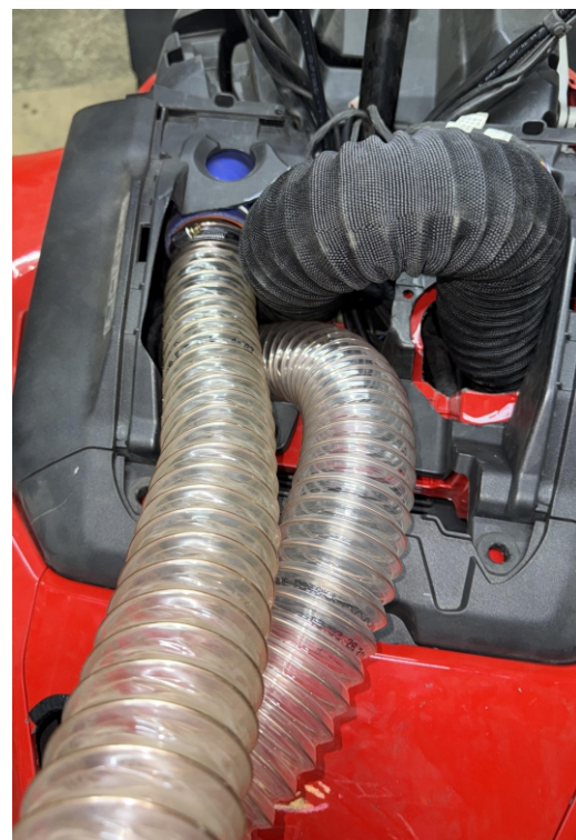
22. Монтируем воздуховод длиной 50 см на впуск двигателя при помощи хомута 50-70 мм из комплекта.
