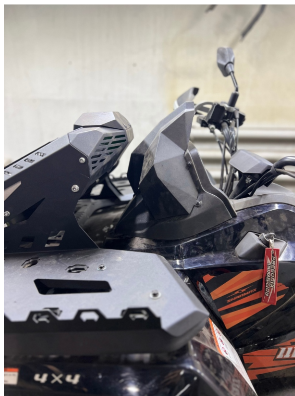
13. Общий вид шноркеля после установки.
