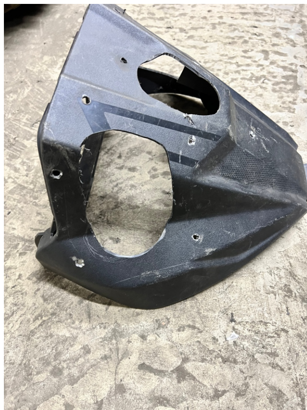
11. Выпиливаем проемы для свободного размещения воздухопроводов. После чего прикручиваем накладку шноркеля на пластиковую крышку. Панель приборов при этом необходимо открутить от пластика.
