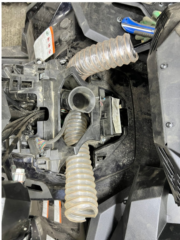
8. Расположение воздухопроводов. Впускной резиновый патрубок двигателя располагаем вертикально вверх путем разрезания его в средней части и стыковкой посредством втулки из комплекта.
