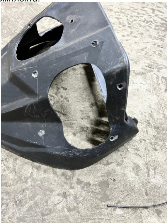
10. На пластиковой крышке размечаем контур накладки шноркеля, плотно прижав к крышке, отмечаем отверстия, сверлим их сверлом д.6мм.
