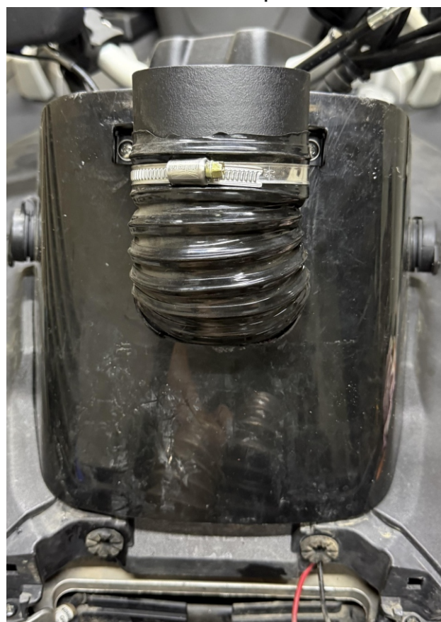
17. Прикручиваем штуцер саморезами из комплекта, выводим воздуховод и фиксируем на штуцере хомутом.
