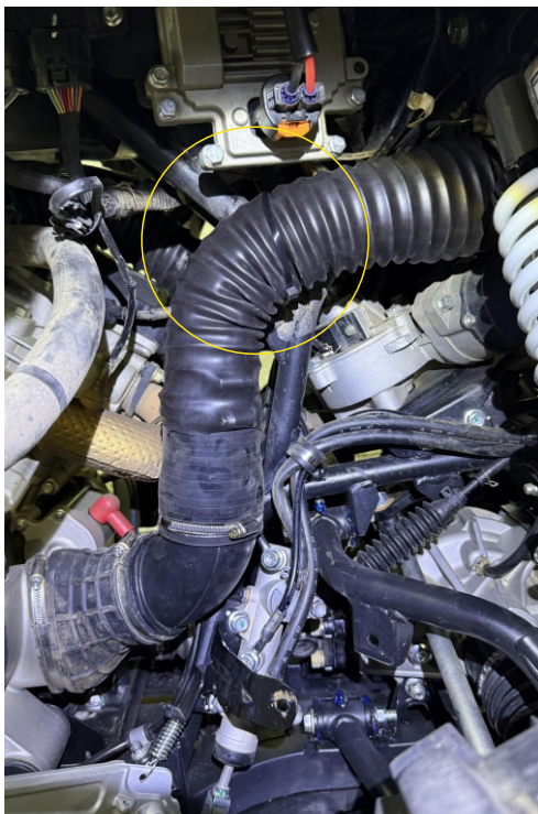
10. Монтируем воздуховод 1м, предварительно усадив в термоусадку на него в растянутом виде. Закрепляем стяжкой к раме.
