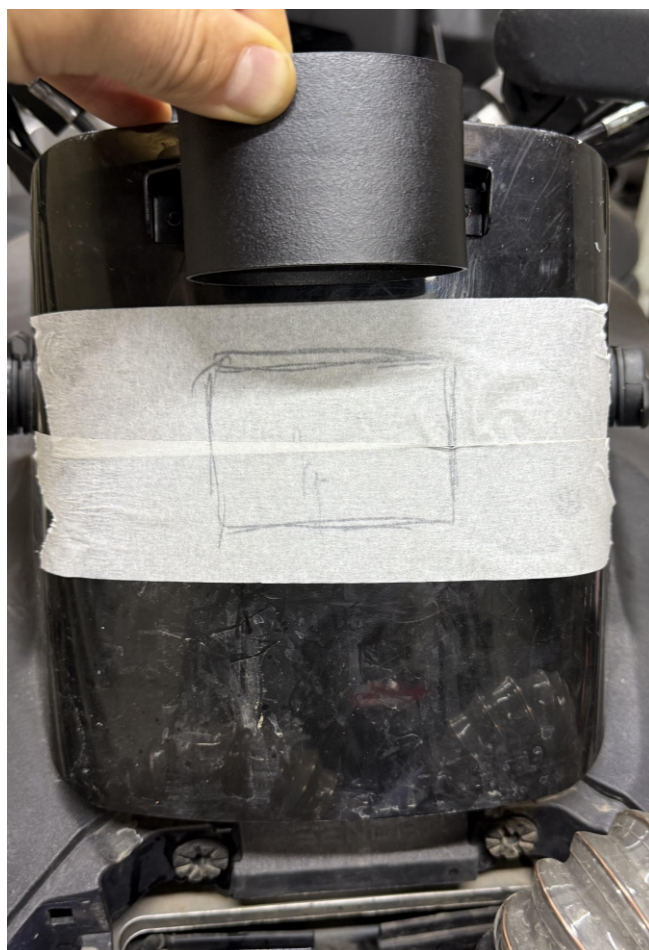
16. Располагаем штуцер шноркеля на пластике щитка приборов, ниже делаем разметку для отверстие прокладки воздуховода, сверлим отверстия d3мм для крепления штуцера
