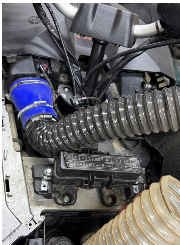
16. Устанавливаем силиконовый переход на штатный хомут и втулку из комплекта, используем 50 см воздуховода 63мм, фиксируем его на хомут 50-70мм из комплекта.
